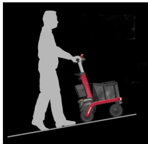
ヒューマノイドロボット ASIMO で培った歩行理論をもとに“倒立振子モデル”に基づく効率的な歩行をサポートする歩行訓練機器である
