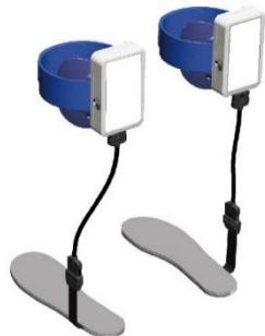
インソールに組み込まれた圧力センサーから歩行パラメータが出力される。その他の機能訓練支援機器のソフトウェアにおいて歩行パラメータを活用することで、一般的な歩行に関する評価項目（歩行速度、歩幅、足圧、ケイデンス、など）が取得可能となる。なお、外部機器となるその他の機能訓練支援機器へは、無線通信規格 Bluetooth class2 にて歩行パラメータを送信することができる。
